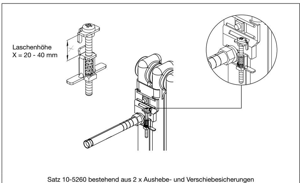
Satz 10-5260 bestehend aus 2 x Aushebe- und Verschiebesicherungen
