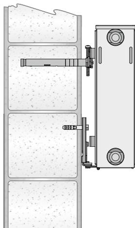
**Aushebe- und Verschiebesicherung**
