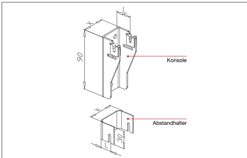
Satz besteht aus 2 Konsolen, 2 Abstandhaltern, 2 Schrauben (8 x 60 mm) und 2 Dübeln (10 mm).
