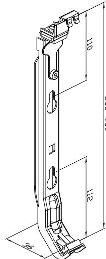
Sätze bestehen aus 2 Konsolen, 2 Schrauben (8 x 60 mm) und 2 Dübeln (10 mm)
