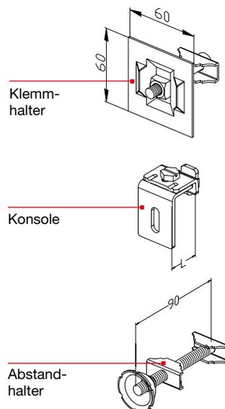
Sätze bestehen aus 1 Konsole, 1 Klemmhalter, 1 Abstandhalter, 1 Schraube (8 x 60 mm) und 1 Dübel (10 mm)
