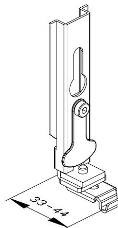
Satz 10-526 besteht aus 2 x Aushebe- und Verschiebesicherung und 2 x Abhebesicherung
